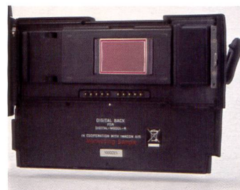
Alles in der Rückwand: der Sensor kommt genau in der Bildebene der Kamera zu liegen.
