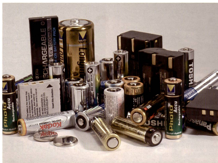
Batterien und Akkus – nicht nur im Sprachgebrauch verwechselt man die beiden Technologien oft. Prinzipiell gilt: Batterien sind nicht wiederaufladbar, da sich Ihre Anode auflöst.
