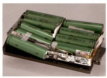
Ein Lithium-Ionen Akku eines Laptops von innen: Er besteht aus hintereinandergeschalteten einzelnen Zellen. Die neue Lithium-Polymer-Technologie erlaubt nun auch die Konstruktion von nicht formgebundenen Einzelzellen, meist wie kleine flache Beuter ausgelegt.
