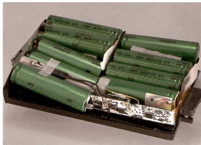
Ein Lithium-Ionen Akku eines Laptops von innen: Er besteht aus hintereinandergeschalteten einzelnen Zellen. Die neue Lithium-Polymer-Technologie erlaubt nun auch die Konstruktion von nicht formgebundenen Einzelzellen, meist wie kleine flache Beuter ausgelegt.
