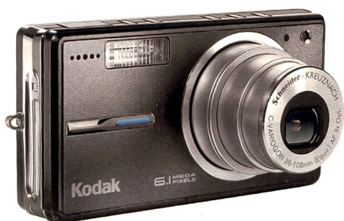
Kodak Easy Share V603: Bildbearbeitung «On Board» und Fernseh-Videoqualität mit 6,1 Megapixel Auflösung.
