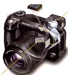
Im A-Modus übernimmt ein zusätzlicher kleiner CCD mit 92% Bildabdeckung hinter einem halbdurchlässigen Spiegel die Aufgabe des Livebildes – ausreichend für alle bewegten Bilder.
