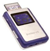
Die schnelle portable Harddisk DigiMate III ist bedienerfreundlich, multifunktional, klein, langlebig und bietet einen Download von 1 GB innert nur 7 Minuten. Der Lithium-Ion Wechsel-Akku hat eine Kapazität von 1200mAh, was für den Download von über 10 GB mit einer Ak-
