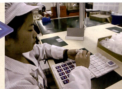
Kontrollen sind in der Speicherkartenproduktion enorm wichtig. Jede einzelne Karte durchläuft einen Burn-in-Test mit extremen Temperaturen. Unten: Die kleinste Speicherkarte.
