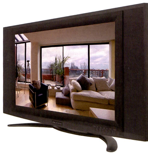
LC-Bildschirme haben einen Siegeszug an den Computern angetreten, da sie eine scharfe Bilddarstellung bieten, eine geringe Bautiefe und keine Strahlenbelastung haben. Inzwischen bieten sie auch gleichbleibende Farben bei unterschiedlichen Betrachtungswinkeln. (Bild JVC Fernseher)
