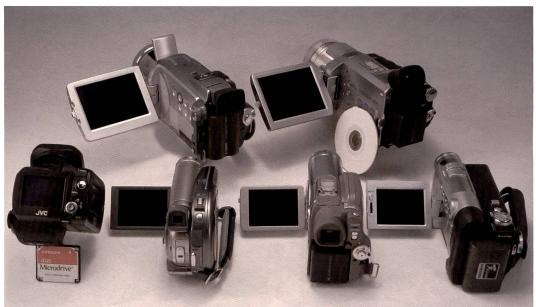
Die Kombination von elektronischem Sucher und ausklappbaren Bildschirm hat sich beim Camcorder etabliert. die Qualität ist durchgängig sehr gut. JVC geht bei der kompakten Everio einen anderen Weg mit nur einem Display und verschränkbarem Kamerabody.
