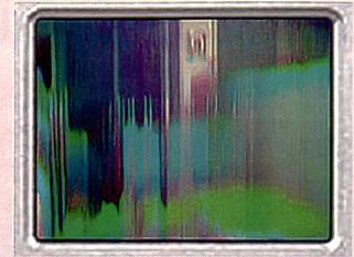
**Die fehlerhaften Sony-CCDs führen zu keiner oder verschmierten Bildschirmsdarstellung. (Bildbeispiel: Konica Minolta)**
