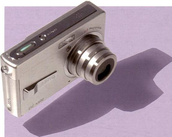
Nur 1,9 cm «dünn» ist die BenQ X600, die ausserdem über einen 6-MPix-CDD, ein Pentax-Dreifachzoom und ein 2,5"-Display verfügt.
