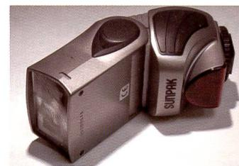
steckblitz weist Leitzahl 40 auf. Sein Reflektor lässt sich vertikal um 90 Grad schwenken, so dass jederzeit indirekt über eine weisse Decke geblitzt werden kann. Der Zoomreflektor passt sich automatisch der verwendeten Brennweite an, so dass das Blitzlicht in korrektem Winkel abgegeben wird.
