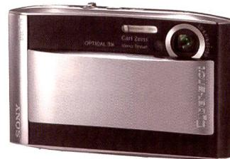
Die kleine und kompakte Sony Cyber-shot T5 mit der Schiebeklappe wiegt 139 Gramm (inkl. Akku und Memory Stick) und misst 93,5 x 60 x 15,3 mm (bzw. 20,3 bei ausgefahrenem Objektiv). Zum Innenleben: Ein CCD-Sensor mit 5,1 Megapixel liefert im Zusammenspiel mit dem Carl Zeiss Vario-Tessar Objektiv gestochen scharfe Bilder. Trotz des dünnen Gehäuses hat die T5 einen 3fachen optischen Zoom zu bieten, der einer Brennweite von 38 bis
