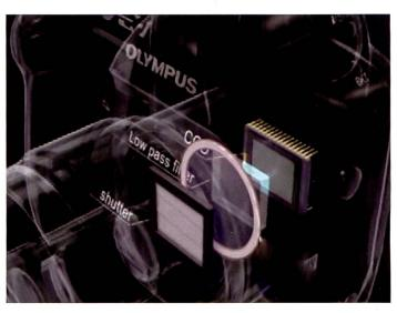
Der Olympus Super Sonic Wave Filter, rund, liegt zwischen Verschluss und Sensor und schliesst diesen dicht ab. Aussen haftender Staub wird beim Einschalten mit Ultraschall auf eine kleblige Folie darunter geschüttelt.
