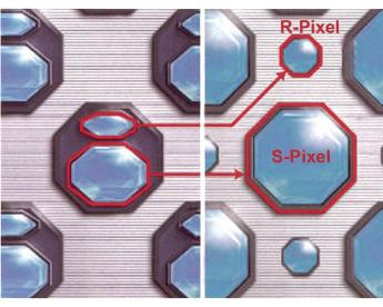
Der Super CCD SR (links) und der Super CCD SR 2 (rechts) von Fujifilm, letzterer mit verbesserter Platznutzung. Die wabenförmige Struktur verhindert weitgehend Struktur-Interferenzen mit dem aufgenommenen Motiv.
