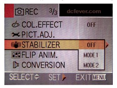
Panasonic Mega 0.1.5 Bildstabilisator mit zwei Einstellungen. Bei der ersten wird bereits das Sucherbild stabilisiert, bei der zweiten erst beim Auslösen, wodurch mehr Einstellweg der Linse zur Verfügung steht.
