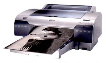
Der 8-Farben Profidrucker Epson 4800 druckt bis Format A2 - ebenfalls mit den neuen Ultrachrom K3 Tinten. Er ist auch als Postscript-Version und mit einem RIP verfügbar.
