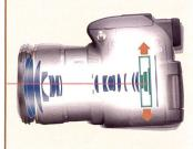
Die in Spiegelreflex-Objektiven eingesetzten Systeme (meist abschaltbar) sorgen dafür, dass Bewegungen der Kamera beim Fotografieren (Verwacklungsunschärfe) ausgeglichen werden. Bei der Bildstabilisation werden bewegliche Linsengruppen (z.B. in Öl schwimmend) eingesetzt. Kreiselsensoren ermitteln jeweils die vertikale und horizontale Bewegung des Objektivs und steuern die Gegenbewegung der optisch stabilisierten Linsengruppe. So entstehen erst bei grösseren
