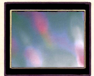
Digitalsensor (Kodak 22 Mpix) mit aufgedampften Farbfiltern.
