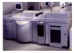
**Die Kodak Nexpress** Digitaldruckmaschine, hier im Einsatz bei der Druckerei Schmidt-Fehr, eignet sich dank neuem fünften Druckwerk mit der Option für Sonderfarben und Coating gut für Fotobücher.
