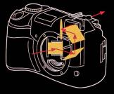
DIE INNOVATIVE LICHT-FÜHRUNG DURCH DAS TTL SPIEGELSUCHER-SYSTEM ERSETZT EIN PENTA PRISMA UND MACHT DIE BAUWEISE EXTREM KOMPAKT.
