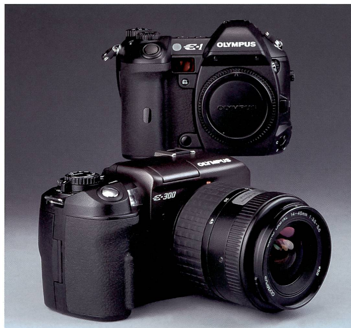
Die Olympus E300 überrascht mit einem TTL-Spiegelsucher, das typische Pentaprisma hingegen (hinten an der E1) fällt weg. Fotos: Werner Rolli
