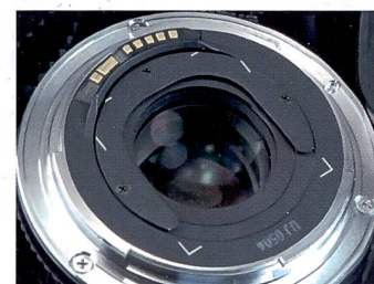
Aufgrund der gewölbten Frontlinse muss das Gelatine-Filter im Bajonett eingesetzt werden.
