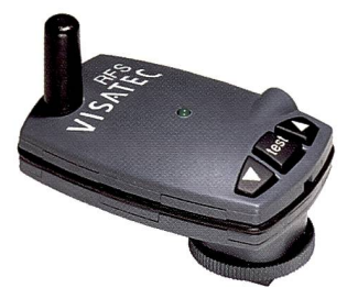
Auslösezubehör ist dank der fortschreitenden Miniaturisierung äusserst handlich geworden, wie einige Beispiele zeigen: Hensel hat den Empfänger in den Generator eingebaut. Die Minisender von Multiblitz und Visatec RFS ermöglichen eine Leistungssteuerung über Funk.
