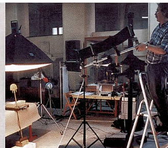
Das improvisierte stationäre Studio im Museum mit drei Sets. Fotografiert wird mit einer Sinar 4 x 5" Fachkamera und mit Bronco-Studiolicht.
