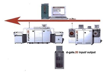
Der komplette digitale Workflow des Agfa d-ws wurde auf eine Leistung von 20'000 Bildern pro Stunde ausgelegt.
