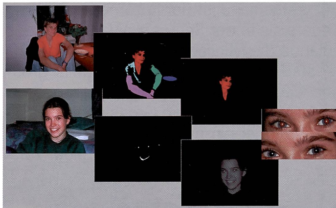
Ablauf «Rote-Augen»-Korrektur: Erkennen von Hauttönen, erfassen von möglichen Gesichtsfeldern, Suche nach roten Augen, Erkennen von Gesichtstruktur, Korrektur der roten Augen ohne Antasten des Glanzreflexes.
