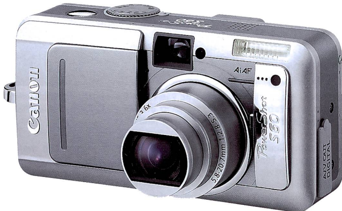
Canon PowerShot S60: Weitwinkel-Zoomobjektiv, schlankeres Gehäuse und einfache Funktionen anstatt mehr Pixel.
