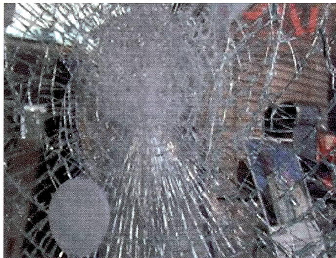
Zertrümmerte Panzerglasscheibe bei einem Einbruchversuch vor wenigen Wochen im Kanton Aargau.
