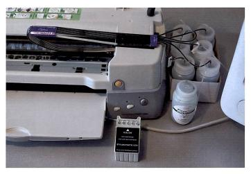
Bei diesem Epson Drucker sind die Tintentanks ausserhalb des Druckkopfes angeordnet. Gedruckt wird mit Grautinten, um eine perfekte Grauwertabstufung zu erreichen.
