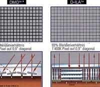
Funktionsweise der Panel-Systeme LCD, DLP/DM und D-ILA.
