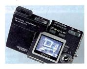
T\*-Zoom. Die T\*-Mehrschichtvergütung verhindert weitgehend Reflexionen im Objektiv, wodurch qualitätsmindernde Einflüsse bei Streulicht, wie es bei Gegenlichtaufnahmen typisch ist, reduziert werden. Das optische Dreifachzoom mit einem Brennweitenbereich von 5.8 bis 17,4 mm (Kleinbild äquivalent: 38 - 115 mm) besteht aus sechs asphärischen Linsenelementen in sechs Gruppen und optischen Spezialgläsern.
