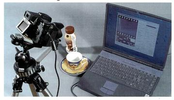
Die Dimage Capture Software macht aus der Konica Minolta eine Studiooder gar Überwachungskamera. Alle Funktionen werden bequem vom PC aus gesteuert. Die Software erlaubt auch die für die wissenschaftliche Fotografie so wichtigen Intervallaufnahmen.
