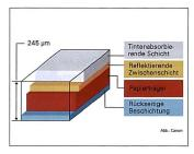
Neben einer tintenabsorbierenden Oberflächenbeschichtung verfügt das Canon Photo Pro Papier zusätzlich über eine Reflexionsschicht und eine Rückbeschichtung für die Planlage.
