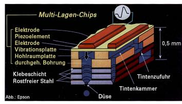
Piezo-Druckköpfe weisen einen relativ komplexen Aufbau und konstruktionsbedingt etwas grössere Abmessungen als Inkjet-Köpfe auf. Die Tinte wird zuerst aus dem Tintenvorrat in den Druckkopf gesaugt. Durch gegenläufige Verformung wird Tinte entsprechend der erforderlichen Tropfengrösse ausgestossen, Satellitentropfen wieder zurückgezogen.
