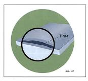
Polymere in der Beschichtung quellfähiger HP-Papiere quellen bei Kontakt mit der Tinte auf. Nach dem Trocknen umschliesst die Beschichtung die Farbstoffe.
