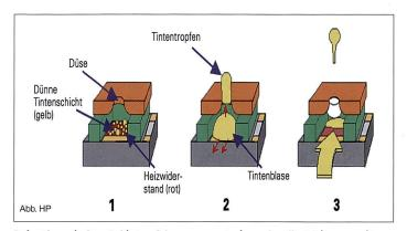
Beim thermischen Inkjetverfahren erzeugt eine schnelle Erhitzung mit 100°C/µsek eine eigentliche Dampfexplosion in der Tinte (1). Die Blase vergrössert sich, es entsteht ein Tintentropfen und Tinte wird ausgestossen (2). Anschliessend kollabiert die Blase, worauf der Druckkopf wieder neu gefüllt wird (3).
