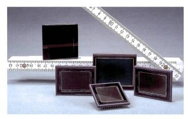
Verschiedene Grössen von CCD-Digitalsensoren, wie sie in Sinar-Digitalbacks verwendet werden. Auch bei den Profisystemen geht der Trend zu mehr, dafür etwas kleineren Pixeln, der zurzeit grösste Sensor – von Sinar und Kodak entwickelt – hat 22 Millionen Pixel mit 9 μ Pixelkantenlänge. Der «kleine» 4-Megapixel-Sensor hatte noch 12 μ Pixelkantenlänge. Aktuelle Sensoren von Kompaktkameras weisen sogar Pixelgrössen unter 2 μ Kantenlänge auf.
