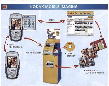
So stellt sich Kodak den Ablauf ab Fotohandy vor: Der Kunde gibt die Bilder direkt per Infrarot oder Bluetooth in die Kodak Order Station, wo sie ausgedruckt und/oder auf CD gebrannt werden, oder er schickt die Bilder per entsprechenden Softwareknopf im Handy ins Labor zum Ausbelichten.
