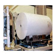
Die Herstellung von Fotopapier erfolgt in einem kontinuierlichen Prozess. Die riesigen Papierrollen werden beschichtet und konfektioniert. (Kodak Harrow)
