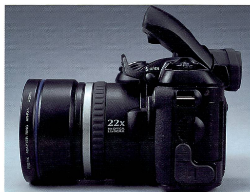
Die Fujifilm S5000 überrascht durch das optische Zehnfachzoom, mit Digitalzoom kombiniert ergibt das einen 22fachen Zoombereich.
