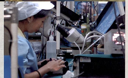
Die Montage der neuen Nikon D2H erfolgt in Gruppen, was für die jungen Frauen ergonomischer und motivierender ist als die frühere Fließbandarbeit.
