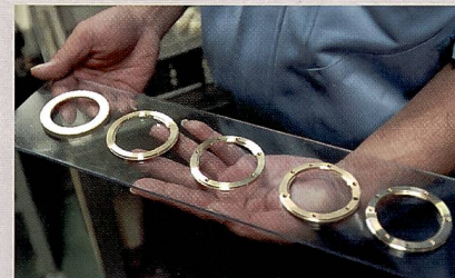
Die Objektiv-Anschlüsse bestehen aus verchromtem Messing und sind damit extrem widerstandsfähig.
