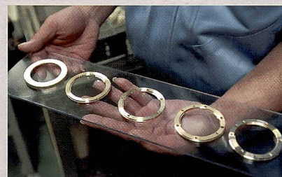
Die Objektiv-Anschlüsse bestehen aus verchromtem Messing und sind damit extrem widerstandsfähig.
