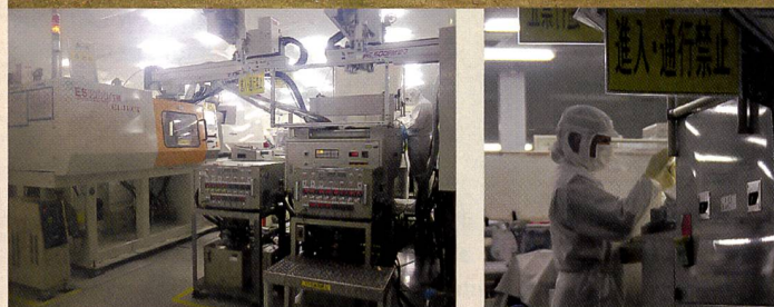
Online Produktion von Tintenpatronen in einem Reinraum.
