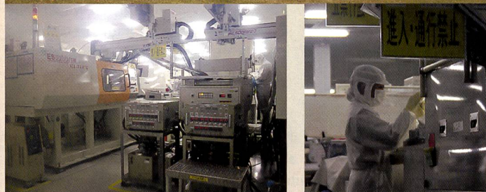
Online Produktion von Tintenpatronen in einem Reinraum.
