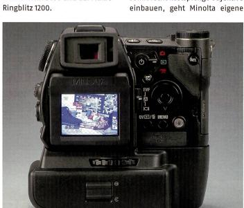
Als einzige im Test verfügt die Minolta A1 über einen ausklappbaren Bildschirm und ein Livebild – ideal für bodennahe Aufnahmen. Da sie keine Spiegelreflexkamera ist, ist das Sucherbild digital, was das Auge irritiert.
