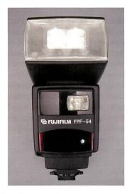
Die Blitzleuchtzeiten betragen 1/200 s bei voller Lichtleistung, 1/600 s bei halber und 1/1400 s bei Viertelleistung. Die Farbtemperatur beträgt 5600 Kelvin, die Filmempfindlichkeit lässt sich von ISO 6 bis ISO 6400 einstellen.
