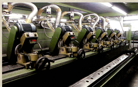
Automatisches Ablängen der Rohrprofile.
