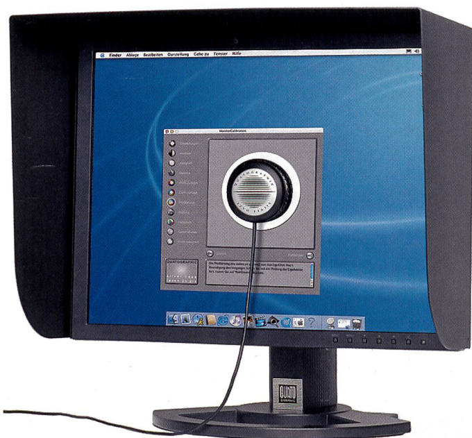
Quatographic Radon 20 Pro mit Mess-Sonde.
