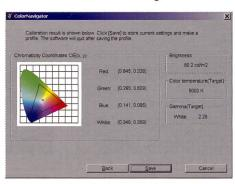
Kalibration auf Weisspunkt D50 (5000 K) und eine Luminanz von 80 cd/m² für die Druckvorstufe.
