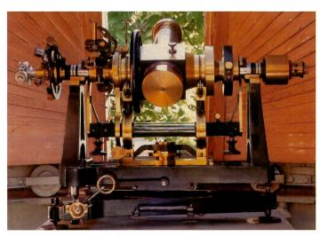
Passageinstrument (19. Jh.) aus der ETH Sammlung Sternwarte. Das Fernrohr kann in der Nord-Süd-Ebene (Meridian) gedreht werden. Die Koordinate auf dem Himmelsäquator, die Rektaszension, wird aus der Zeit des Durchgangs des Sterns durch den Meridian bestimmt.
