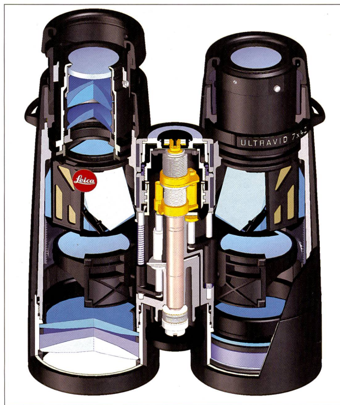
Innenansicht eines Leica Duovid Fernglases. Durch aufwändige Prismensysteme wird das Bild gedreht und erscheint dem Betrachter standrechtig. Ferngläser sind meist mit Gas gefüllt gegen Beschlagen und sind dadurch auch wasserdicht.
