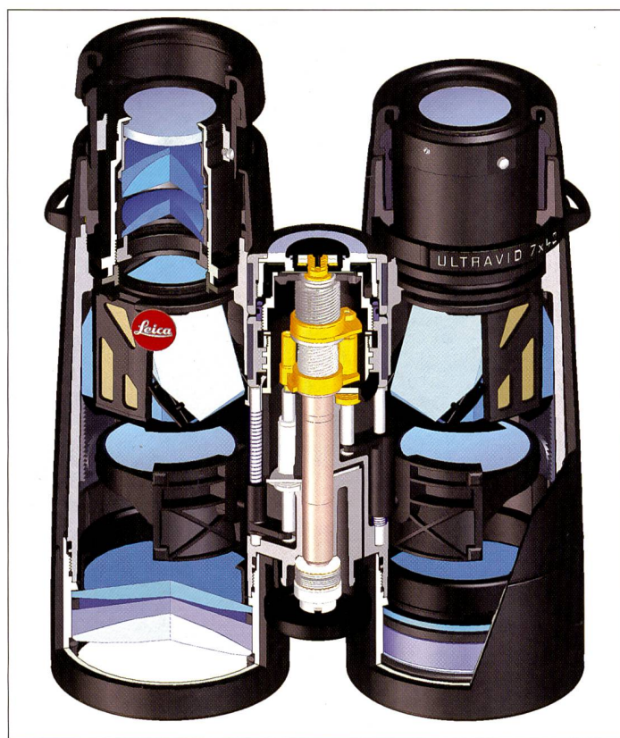
Innenansicht eines Leica Duovid Fernglases. Durch aufwändige Prismensysteme wird das Bild gedreht und erscheint dem Betrachter standrechtig. Ferngläser sind meist mit Gas gefüllt gegen Beschlagen und sind dadurch auch wasserdicht.
