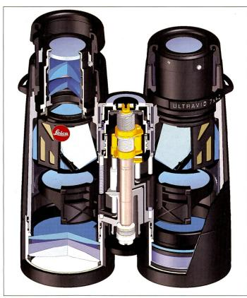
Innenansicht eines Leica Duovid Fernglases. Durch aufwändige Prismensysteme wird das Bild gedreht und erscheint dem Betrachter standrichtig. Ferngläser sind meist mit Gas gefüllt gegen Beschlagen und sind dadurch auch wasserdicht.
