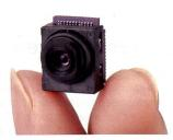
Sharp hat ein CCD-Kameramodul entwickelt, das im Megapixelbereich Kleinste (1,44 cm x 9,7 mm), zurzeit mit 1144 (H) x 880 (V) Pixel. Gedacht ist das Modul für Handys, integriert mit Linse und Prozessor. Weltweit ist eine zunehmende Nachfrage nach Mobiltelefonen mit Kameras zu verzeichnen. Bis vor kurzem waren CIF und VGA Standard für die meisten der in Mobiltelefone inte-
