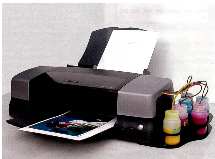
Unsere Versuchsanordnung bestand aus einem Epson 1290 Inkjetdrucker. Statt Tintenpatronen im Druckkopf wurden externe Tanks verwendet.
