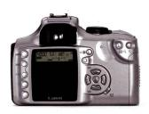
Die EOS 300D setzt dabei auf einen Sensor mit CMOS Technologie und 6 Megapixel Auflösung, auf Autofokus und die Kompatibilität mit bestehenden Objektiven. Die maximale Bildfolge beträgt 2,5 Bilder pro Sekunde bei 4 Bildern in Folge.
