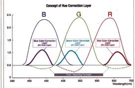
Die Darstellungen der Filmschichten von Velvia 100F und Astia 100F zeigen die Anordnung der Farbkorrekturschichten (Color Correction Layer). Die Farbschichten sind vereinfacht, tatsächlich sind sie mehrfach aufgebaut.
