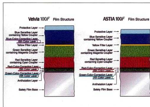
Die Darstellungen der Filmmaterialschichten von Velvia 100F und Astia 100F zeigen die Anordnung der Farbkorrekturschichten (Color Correction Layer). Die Farbschichten sind vereinfacht, tatsächlich sind sie mehrfach aufgebaut.
