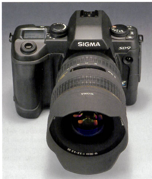
Die Sigma SD9 wirkt etwas bullig, ist aber handlich. Die Bedienelemente sind übersichtlich angeordnet und orientieren sich an der analogen SA9. Der grosse Monitor zeigt auf Knopfdruck die wichtigsten Bildinformationen.
