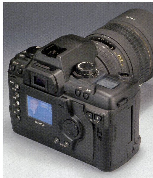
Die Sigma SD9 wirkt etwas bullig, ist aber handlich. Die Bedienelemente sind übersichtlich angeordnet und orientieren sich an der analogen SA9. Der grosse Monitor zeigt auf Knopfdruck die wichtigsten Bildinformationen.
