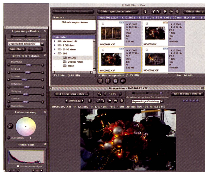
Im Lieferumfang der Sigma SD9 ist das Programm Photo Pro enthalten. Damit werden die Rohdaten in eine TIFF- oder JPEG-Datei umgerechnet. Mit hohem Bedienkomfort sind sofort kontrollierbare Bildkorrekturen möglich, was bei Bilderserien mit gleichen Aufnahmebedingungen sehr nützlich ist.
