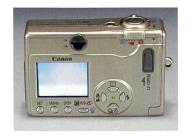
Anzeige auf dem Monitor und beim Transfer an den Drucker oder Computer. Das optische Zweifachzoom (äquivalent 35-70 mm im Kleinbild) wird durch eine 9-Punkt AiAF-Autofokusfunktion unterstützt. Zudem können die Speicherung der Schärfe und der Belichtung gekoppelt werden. Die Auflösung des Sensors liegt bei 3,2 MP. Canon liefert umfassende Software mit, so beispielsweise ein Stitch-Programm, mit dem sich Panoramabilder aus mehreren Einzelbildern anfertigen lassen.
