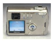
nitorhelligkeit und eine Anzeige mit +/- Symbol und der Angabe der Über- und Unterbelichtung in Drittelsstufen kontrolliert wird. Das Besondere an der Optio 430 RS ist die 3D-Funktion, mit der die Kamera - wie übrigens auch die anderen Optio-Modelle - ausgestattet. Damit gelingen Stereoaufnahmen (siehe Fotointern 11/02, 15/02). Ein Stereoviewer für die Betrachtung der ausgedruckten Bilder wird mitgeliefert.
