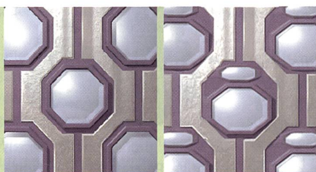
Die Pixelanordnung des Super-CCD der dritten Generation (links) und der neue Super-CCD-SR der vierten Generation (rechts).
