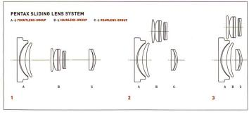
Mit dem Pentax Sliding Lens System wird bis 55 % Platz gewonnen, in dem eine Linsengruppe in eine zweite Ebene verschoben wird.
