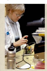
Ist der Spiegel eingesetzt, wird die Kamera per Laserstrahl ausgemessen. Die Testeinrichtung wurde im Haus entwickelt und gebaut.
