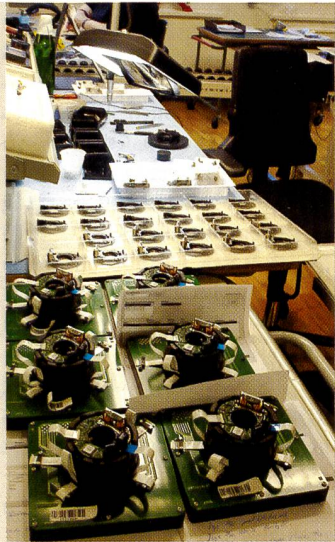
Der Zentralverschluss wird auf einer Platine montiert...
